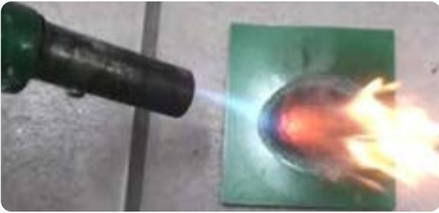
화재발생 시 연소되면서 유독가스 발생 및 화재 전이 문제 발생
