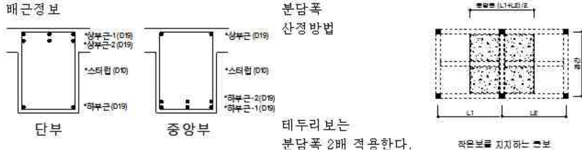
<표 0406.5> 2층 및 평지붕의 작은보를 지지하는 큰보의 설계
