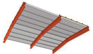
M-DECK 설치시 Purlin 없는 모습
