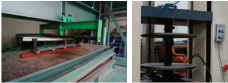
IMS 시스템 압축실험 및 적설하중 시험
