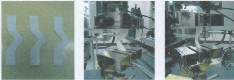
[그림-6] 인열강도[웹브릭 미포함] 시험편 및 시험 사진
