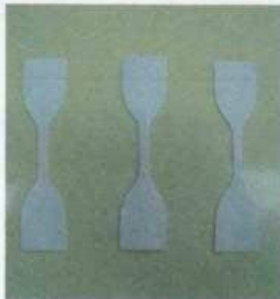
[그림-5] 인장성능[웹브릭 미포함] 시험편 및 시험 사진
