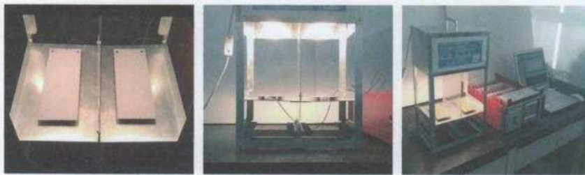
[그림-10] 표면온도 시험편 및 시험 사진
