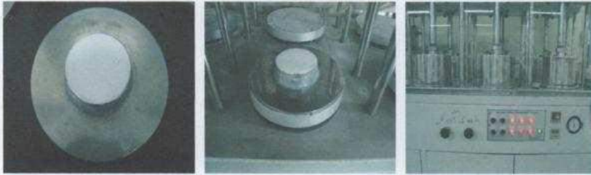
[그림-9] 내투수성[에코클루프 시스템] 시험편 및 시험 사진
