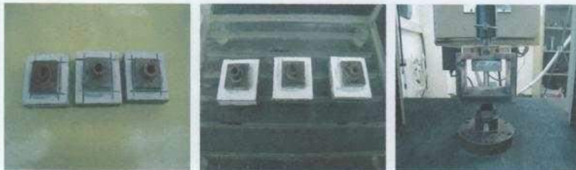
[그림-8] 부착강도[에코롤루프 시스템] 시험편 및 시험 사진
