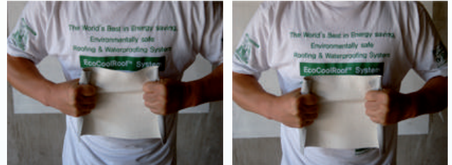
스티치 본딩법으로 제조된 에코루프® 웨브릭에 방수재를 합침/건조 후 당겼을 때
