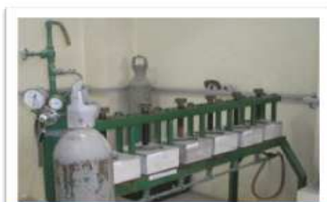
시험 콘크리트 하부에서 수압 test 0.1~0.7MPa
