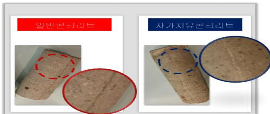
[사진5] 일반콘크리트와 자가치유 콘크리트의 균열자가치유기능 비교
