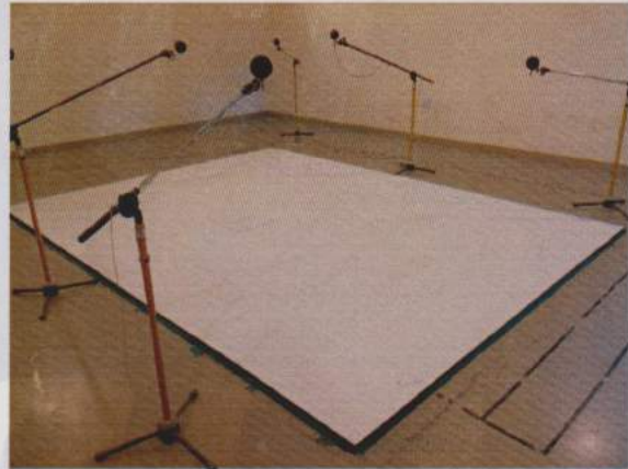
< 사진 2. 시험체 설치모습 2 >
